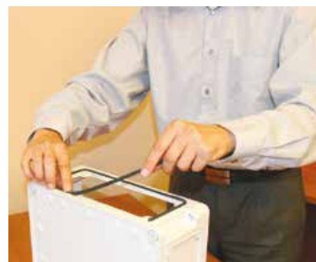
3. Установите уплотнитель на оба объединяемых корпуса
